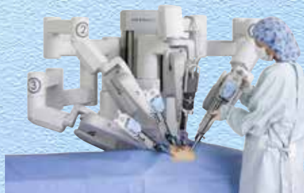
ペイシェントカート (ロボットが術者の手となり手術をする)
